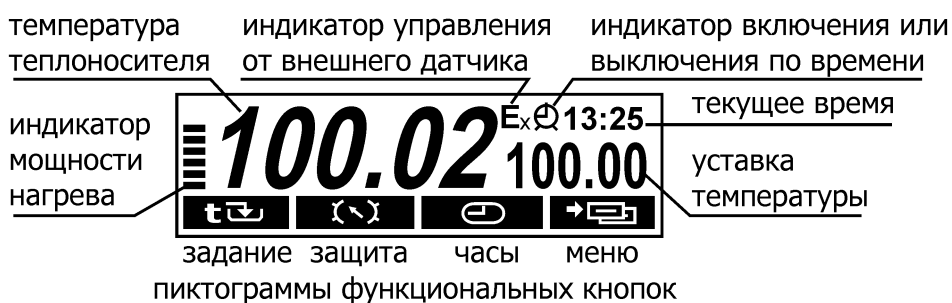
Рисунок 4 — Дисплей в режиме регулирования по уставке
