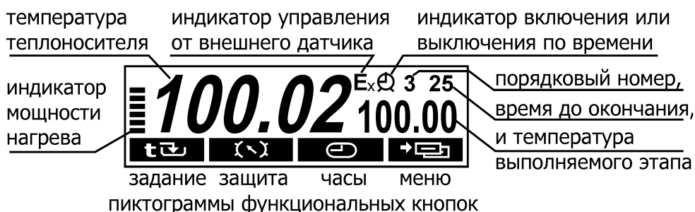
Рисунок 5 — Дисплей в режиме регулирования по программе
